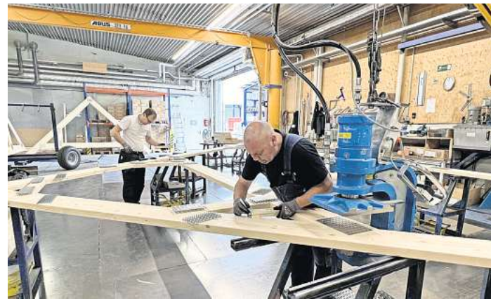
Handarbeit: Holger Fischer bereitet einen neuen Dachstuhl vor.
